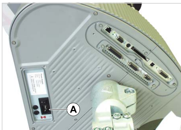
[33] Power supply (A) on the ALS 20x
