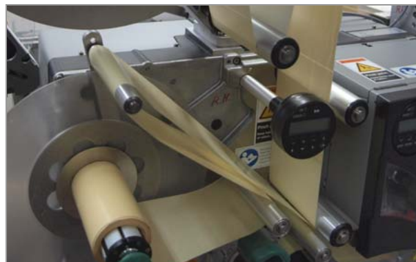
[62] Pasar el papel portante alrededor del brazo bailante y los rodillos de inversión.
