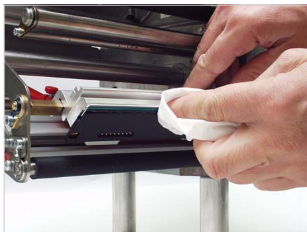
[97] Limpiar el cabezal de impresión con alcohol.
