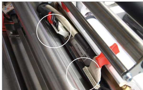
[101] Pose du câble de raccordement de manière à éviter tout contact avec le ruban transfert.
