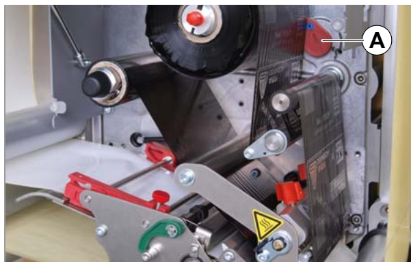
[78] Bouton de réglage pour la compression de la tête d'imprimante (A)
