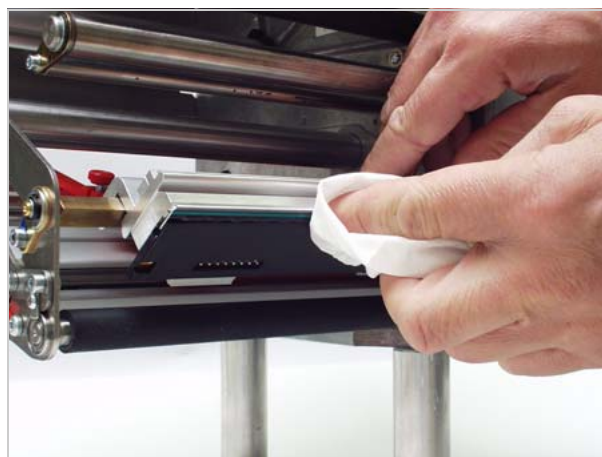
[97] Nettoyage de la tête d'imprimante avec de l'éthanol.
