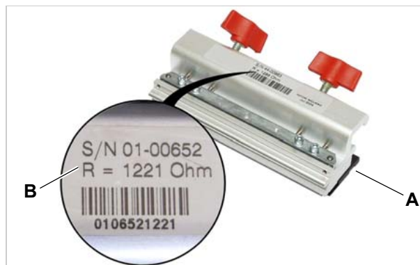
[102]Tête d'imprimante (A) avec marquage de la résistance (B), dans notre exemple : 1221 Ohm.
