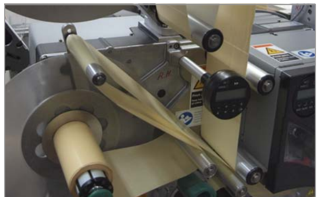
[62] Inserire la carta di supporto su braccio semovibile e rulli di rinvio.
