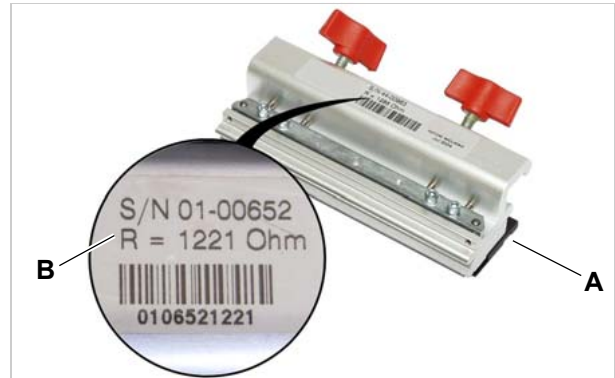
[102] Testina di stampa (A) con indicazione della resistenza (B), in questo caso: 1221 Ohm.
