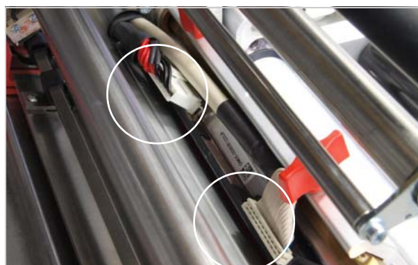
[101] Posicionar o cabo de conexão de maneira que esta não toque a folha.
