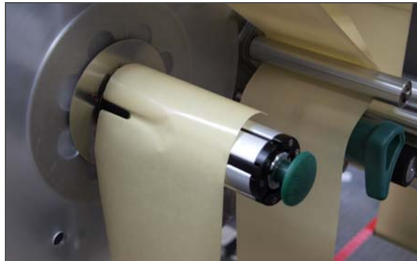
[63] Prender fixamente o papel portador no enrolador.
