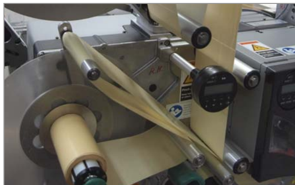
[62] Levar o papel portador ao redor do braço do balancim e os rolos deflectores.
