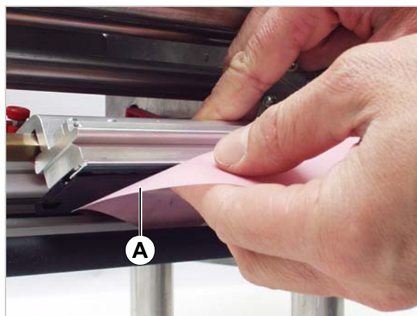
[64] Nettoyage de la tête d'imprimante avec papier nettoyant.
