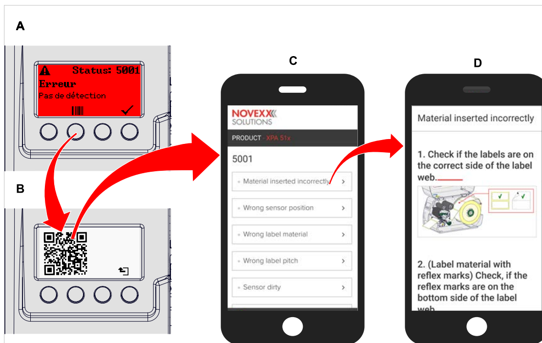
Image 56: Si le message d'erreur possède un symbole Code-barres (A), il est possible, par le biais d'un code QR (B) de faire afficher une notice pour l'élimination d'erreurs (C) sur le smartphone.
