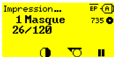
Image 45: Alarme ruban transfert pendant une tâche d'impression: le fond est jaune, le symbole du ruban transfert clignote.
