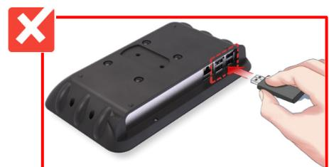
**Attention** : la clé doit être introduite dans le port USB de l'imprimante et non dans le panneau de commande.
