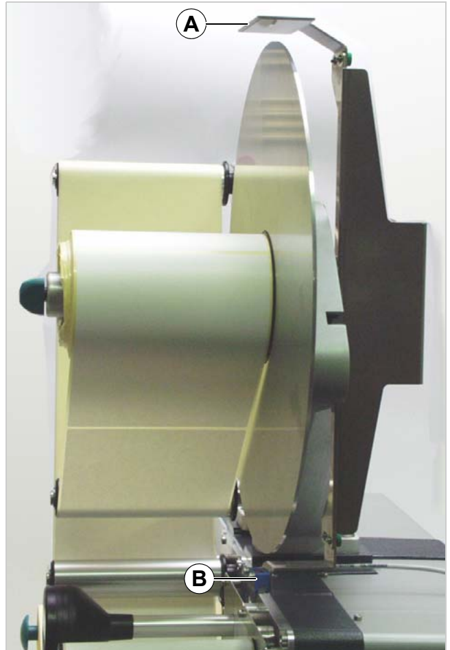
[73] Externe RD-Lichtschanke montiert - Seitenansicht. A Reflektor B Sensor
