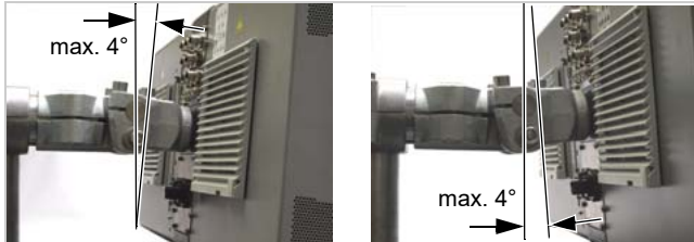
[22] Schwenkbereich des verstellbaren Kopfgelenks.
