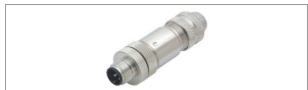
[529] M12-Stecker (Artikelnummer: A8142 für Kabel-Ø 4-6 mm, A8143 für Kabel-Ø 6-8 mm)
