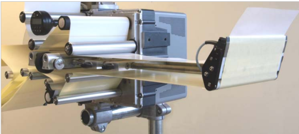
[485] ALS 309 RH with horizontal Euro dispensing edge holder.
