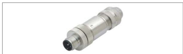
[60] M12-Stecker (Artikelnummer: A8142 für Kabel-Ø 4-6 mm, A8143 für Kabel-Ø 6-8 mm)
