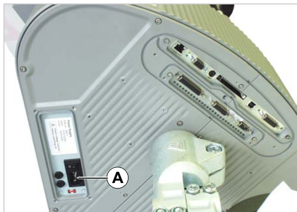
[13] Power supply connection (A) at the ALS 20x / XLS 20x (A) (picture: ALS 20x RH).
