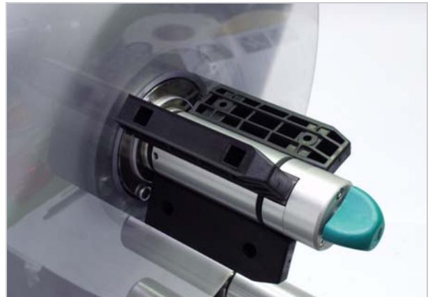
[30] Position der Kernadapter für 101,6 mm Kerndurchmesser.
