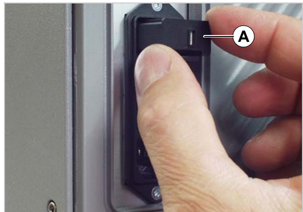
[40] Sicherungseinschub (A) herausnehmen.
