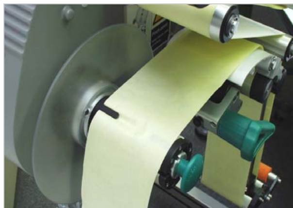
[28] Trägerpapier am Aufwickler befestigen.
