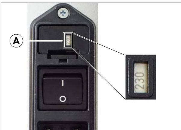
[16] Spannungsanzeige am Sicherungs-Einschub (zeigt hier 230 V an).
