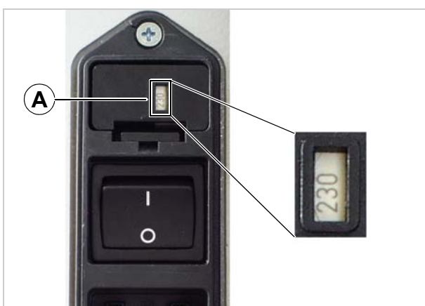
[24] Weergave van de spanning bij de veiligheidsschuij (toont hier 230 V).
