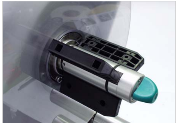
[38] Positie van de adapter voor de binnendiameter, voor een binnendiameter van 101,6 mm.
