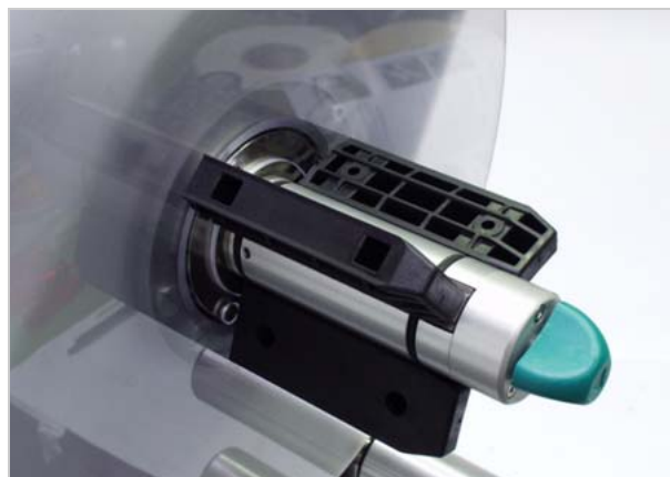
[44] Placering af adapter til etiketrulle med 101,6 mm indvendig diameter.
