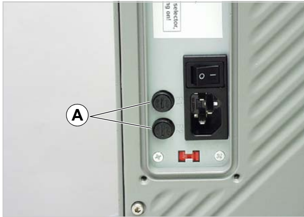
[57] Sikringsholder (A) på ALS 20x.
