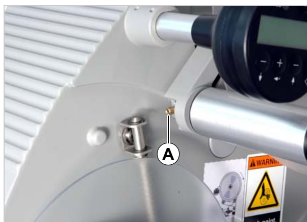
[47] Indstillingsskrue (A) på afviklingsrullens reguleringsarm.
