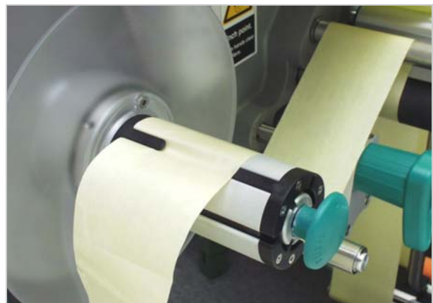
[42] Kiinnitä taustapaperi uudelleenrullaimeen.
