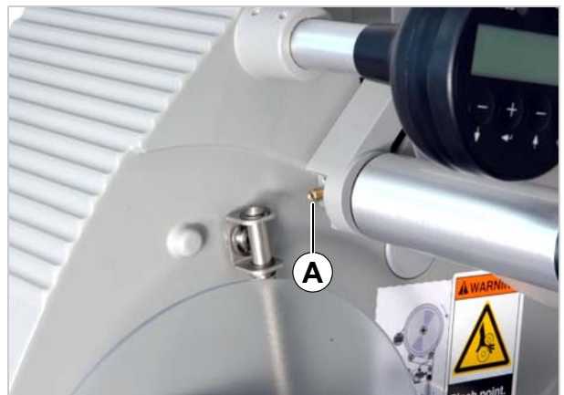
[47] Säätöruuvi (A) purkaimen pingotusvarrella.
