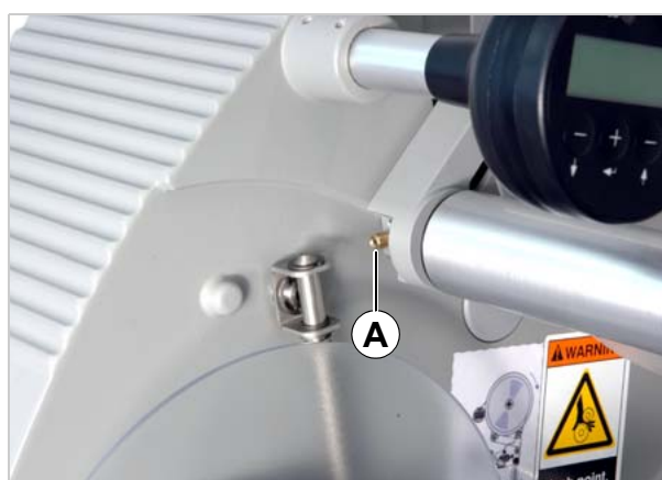
[47] Parafuso de ajuste (A) no braço do balancim do desenrolador.
