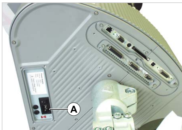
[27] O conector de alimentação eléctrica (A) no ALS 20x.
