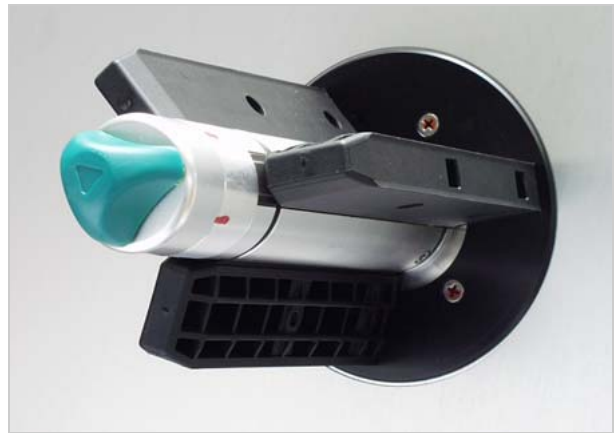
[47] Ydinadapterin paikka 101,6 mm kierteen sisäläpimitalle.
