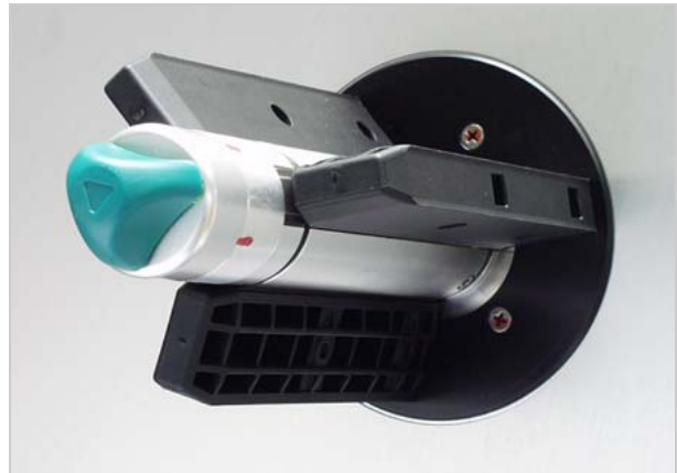
[47] Posizione dell'adattatore del nucleo per un diametro del nucleo pari a 101,6 mm.
