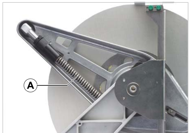
[50] Molla di richiamo (A) sul braccio semovibile dello svolgitore.
