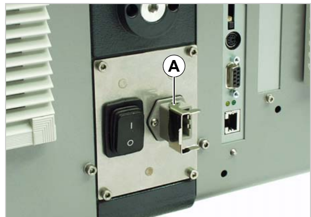
[28] Conexão de rede (A) no ALS 30x.
