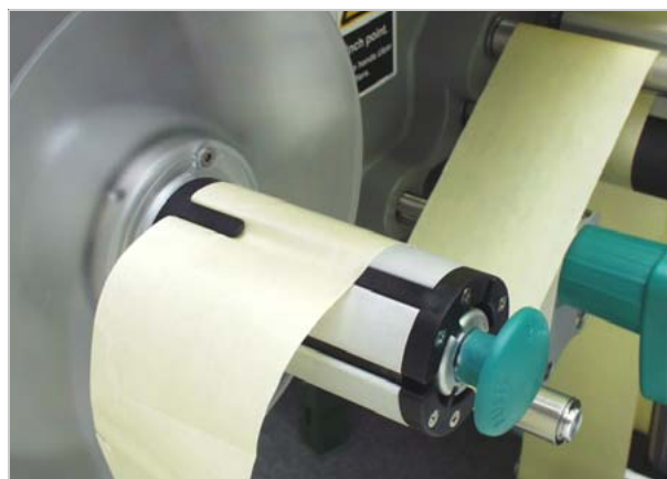
[45] Prender fixamente o papel portador no enrolador.
