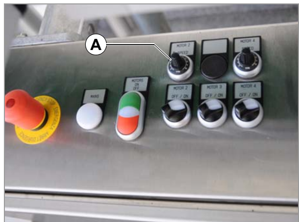
[17] Potentiometer (A) am Schaltschrank der Motorsteuerung (Beispiel: NOVEXX Solutions, Serie AMC).
