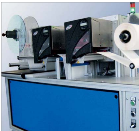
[6] Applicering med to PEM-moduler til tofarvet udskrivning. Der er en bufferløkke mellem de to PEMs. Det betrykte materiale oprulles til venstre.
