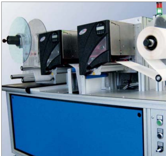
[6] Gebruik met twee PEM-modules voor tweekleurige druk. Tussen de beide PEMs bevindt zich een bufferlus. Links wordt het bedrukte materiaal opgewikkeld.
