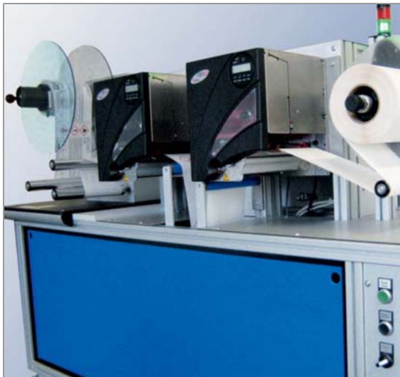
[6] Aplicação com dois módulos PEM para impressão a duas cores. Entre ambos os PEMs encontra-se um laço de reserva. À esquerda é enrolado o material impresso.
