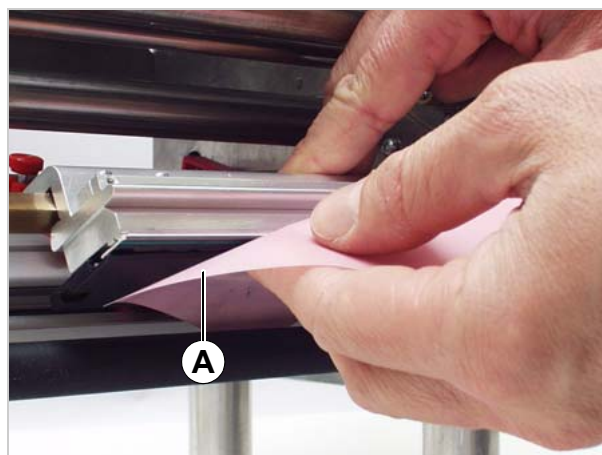
[58] Limpar o cabeçote de impressão com as fitas de limpeza.
