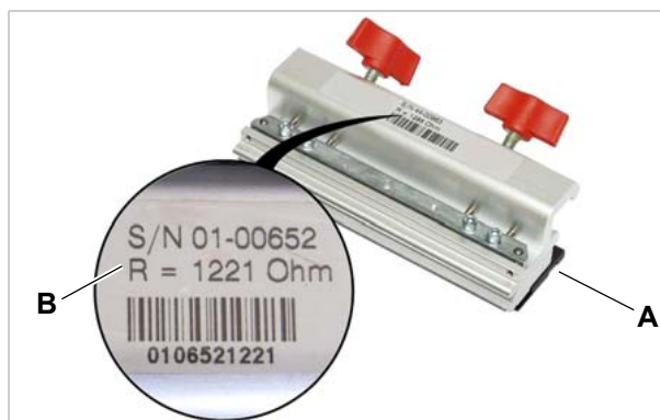
[62] Cabeçote de impressão (A) com identificação de resistência (B), aqui: 1221 Ohm.
