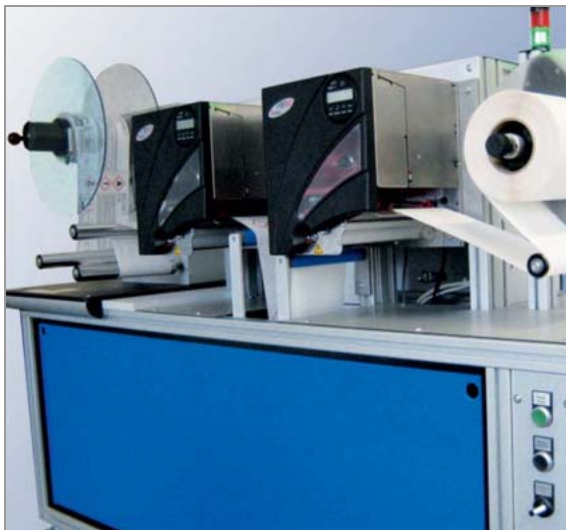
[6] Användning med två PEM-moduler för tvåfärgad utskrivning. Mellan de båda PEM:s befinner sig en buffertslinga. Till vänster rullas det utskrivna materialet upp.
