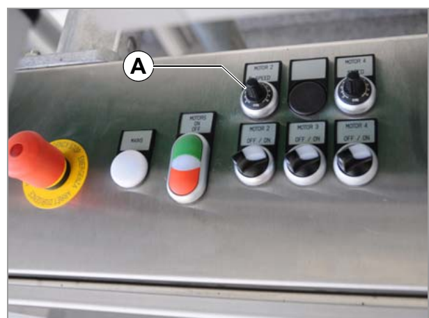
[14] Potentiometer (A) am Schaltschrank der Motorsteuerung (Beispiel: NOVEXX Solutions, Serie AMC).
