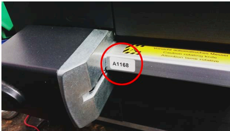
Bild 2: Erkennungsmerkmal: Aufkleber mit Artikelnummer am Messer (hier: Messer 2000 mit 4" Breite).
