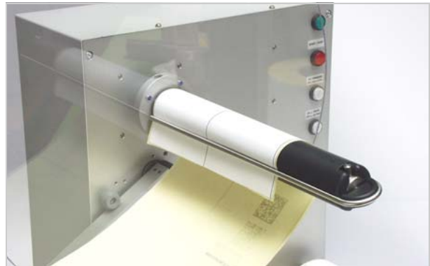
[4] (1,5") Materialende unter dem Klemmbügel festklemmen.
