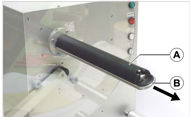
[8] 1,5"-Aufwickeldorn des U-RX. A Aufwickeldorn B Klemmbügel
