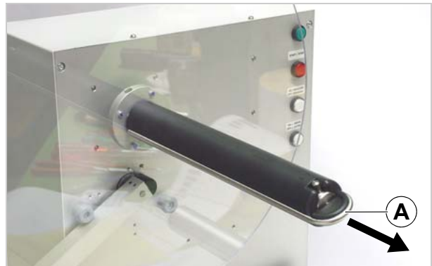
[2] 1,5"-Aufwickeldorn des U-RX. A Klemmbügel
