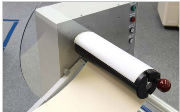
[5] (3"/4") Materialende in den Schlitz im Aufwickeldorn stecken.
