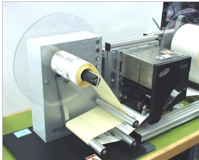
[1] Der U-RX in einer typischen Anwendung: Aufwickeln von Etikettenmaterial nach dem Bedrucken mit einem PEM Druckmodul.
