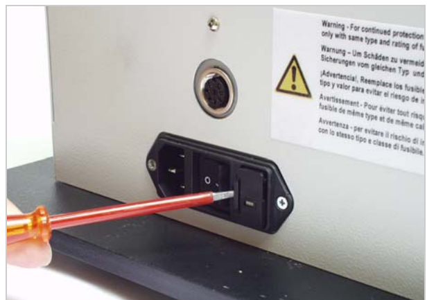
[10] Verriegelung des Sicherungseinschubs mit Schraubendreher öffnen.
