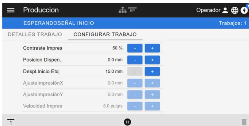
Figura 21: Vista «Configurar Trabajo» de un pedido de impresión en el panel web. Con el rol activo (aquí: «Operador»), los ajustes no accesibles aparecen grises. Los otros ajustes pueden modificarse haciendo clic en «+» o «-».
