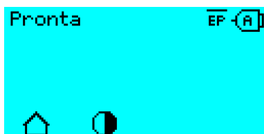
Figura 34: Display «Pronta» sulla macchina pronta per l'esercizio.
