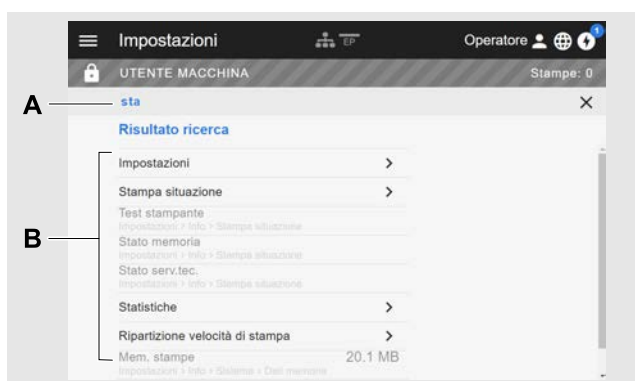
Figura 26: Dopo aver ammesso il termine di ricerca «Testina» (A) appaiono solo i parametri che contengono nel nome la parola «Testina» (B).
