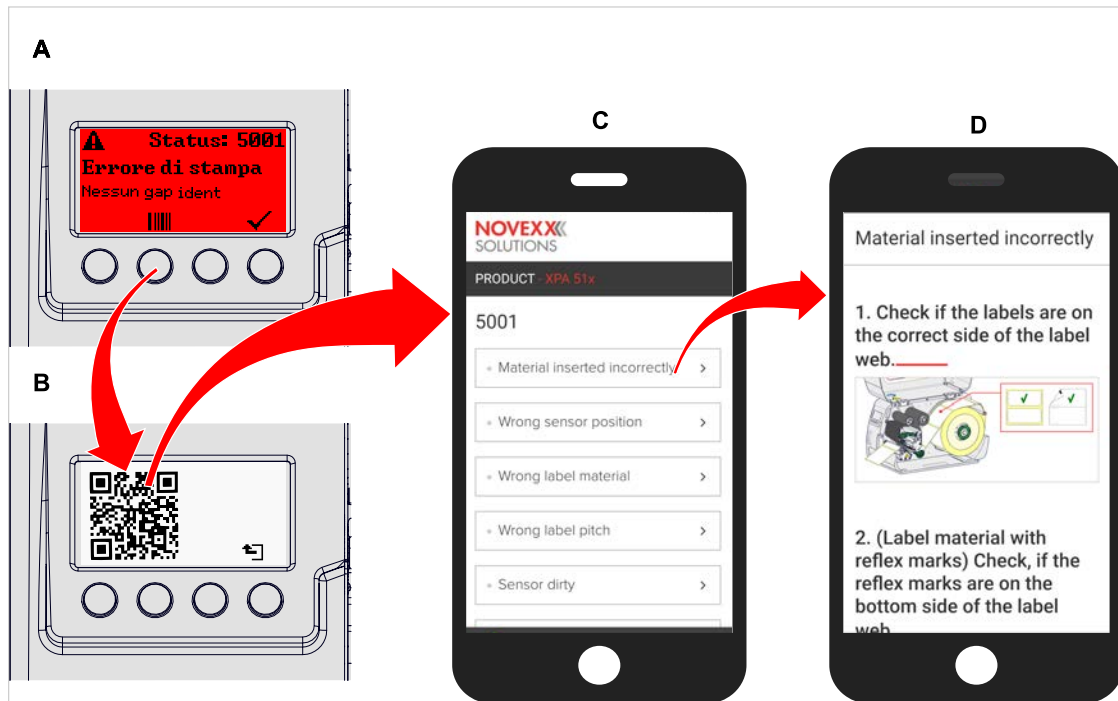
Figura 58: Se il messaggio di errore riporta un simbolo codice a barre (A), è possibile richiamare su uno Smartphone con un codice QR (B) la guida per eliminare gli errori (C).
