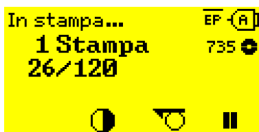
Figura 56: Avviso di fine pellicola durante un lavoro di stampa: lo sfondo è giallo, il simbolo della pellicola lampeggia.
