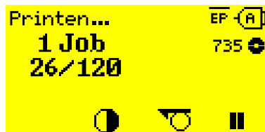
Afbeelding 56: Waarschuwing voor folie tijdens een afdruktaak: De achtergrond is geel, het symbool voor folie knippert.
