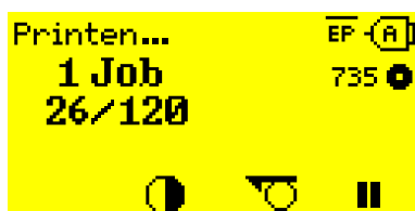
Afbeelding 46: Foliewaarschuwing tijdens printopdracht: De achtergrond is geel, het foliesymbool knippert.
