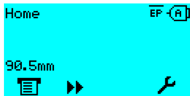
Figura 41: Indicação da distância de etiqueta mensurada.
