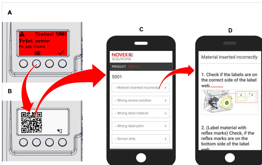
Figura 58: Quando a mensagem de falha apresentar um símbolo de código de barras (A), pode ser chamada, através de um código QR (B), uma instrução para eliminação da falha (C) no Smartphone.
