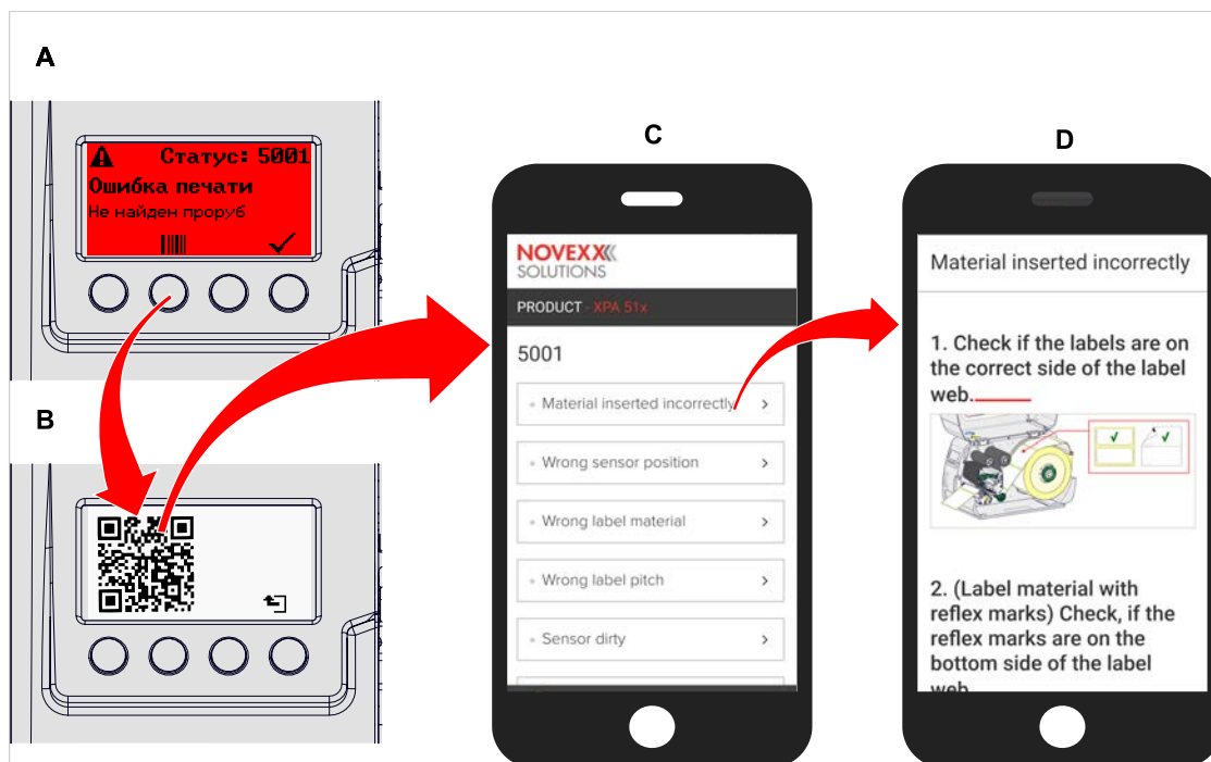
Рис. 58: Если в сообщении об ошибке имеется символ штрих-кода (А), тогда инструкцию по устранению ошибки (С) можно вызывать посредством QR-кода (В).
