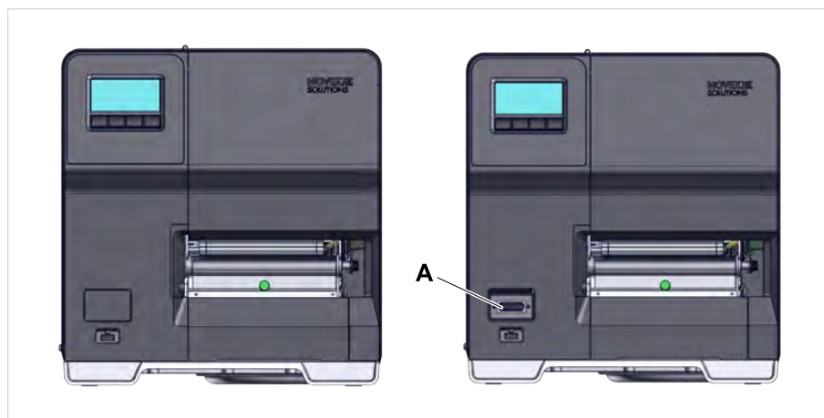
Image 3: Caractéristique de différenciation extérieur: La version Peripheral (droite) est dotée d'un port Sub-D (A) du côté avant, sous le poste de commande (concerne uniquement les imprimantes de la version correspondante, sans autres options internes ).
