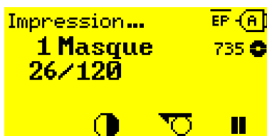
Image 61: Avertissement de fin de ruban pendant un travail d'impression : l'arrière-plan est jaune, l'icône de ruban clignote.
