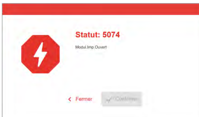
Image 23: Des messages d'erreur nécessitant une réaction de l'opérateur sont affichés sur toute la surface. Le numéro de statut et le texte de statut concordent avec l'affichage sur le panneau de commande de la machine. Le message peut être confirmé soit sur le panneau Web ou sur le panneau de commande de la machine.
