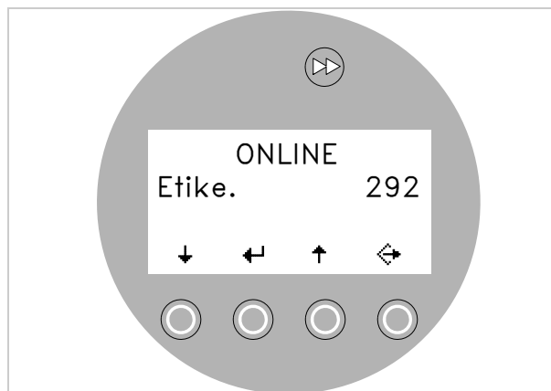
[23] Betjeningspanelet i etiketteringsdrift (292 etiketter påsat)
