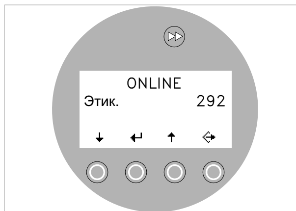
[23] Панель управления в режиме подачи (подано 292 этикетки)
