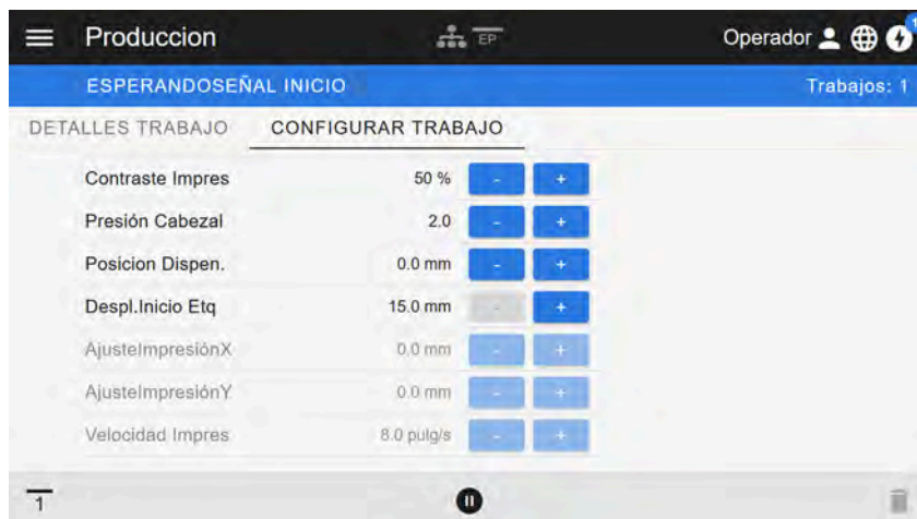
Figura 28: Vista «Configurar Trabajo» de un pedido de impresión en el panel web. Con el rol activo (aquí: «Operador»), los ajustes no accesibles aparecen grises. Los otros ajustes pueden modificarse haciendo clic en «+» o «-».
