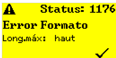
Figura 68: Ejemplo de una alarma
