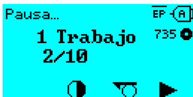
Figura 66: Pedido de impresión detenido. Pulsar la tecla 4 para continuar.
