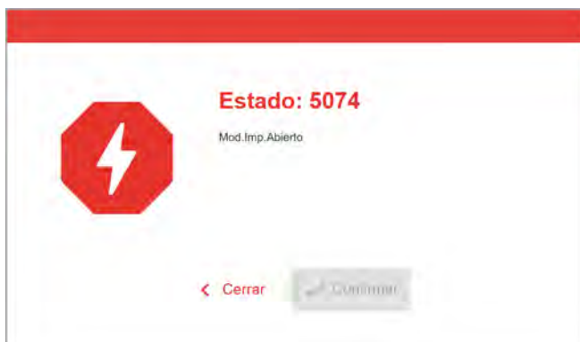
Figura 24: Los mensajes de error que requieren una reacción del operador se muestran completos. El número y el texto de estado coinciden con la indicación en el campo de mando de la máquina. El mensaje puede confirmarse, opcionalmente, en el panel web o en el campo de mando de la máquina.
