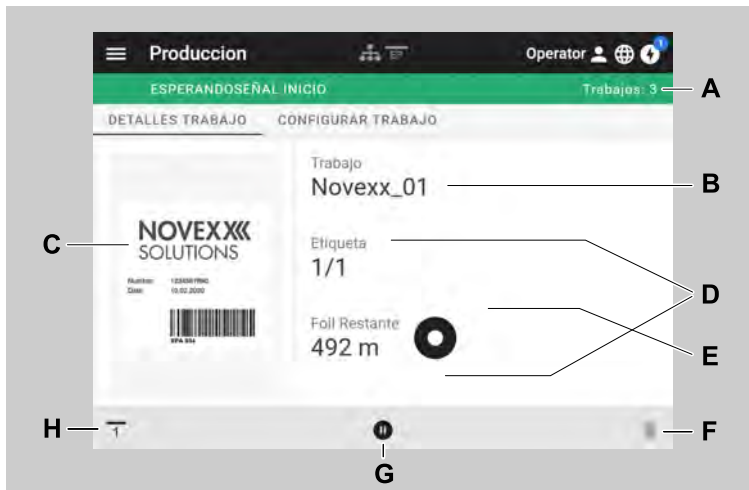
Figura 27: Vista «Detalles Trabajo» de un pedido de impresión en el panel web.
