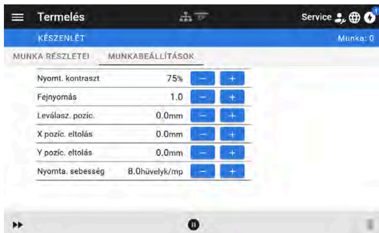
Kép 28: Egy nyomtatási megbízás “Munkabeállítások” nézete a Webpanelen. A beállítást a “+” vagy “-” jelekre kattintva módosítani lehet.
