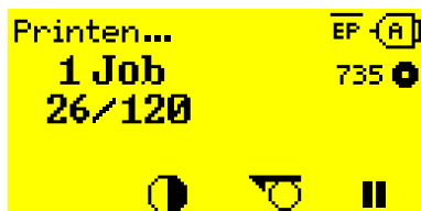
Afbeelding 58: Foliewaarschuwing tijdens printopdracht: De achtergrond is geel, het foliesymbool knippert.
