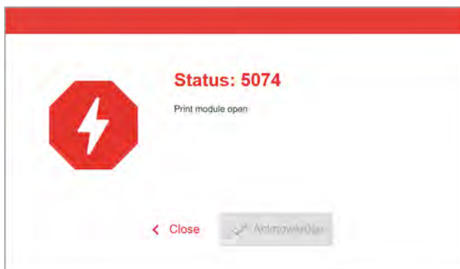
Figura 24: Mensagens de erro que necessitam uma reacção do operador são indicadas em área cheia. Número de estado e texto de estado coincidem com a indicação no campo de comando da máquina. A mensagem pode ser confirmada alternativamente no painel da web ou no campo de comando da máquina.
