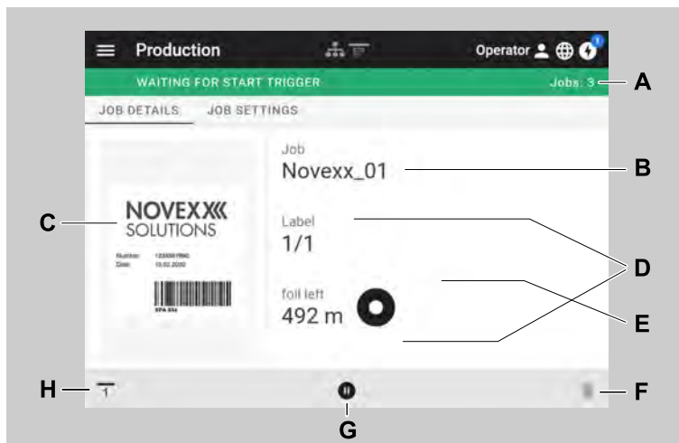
Figura 27: Visualização “Job details” de um job de impressão no painel da web.
