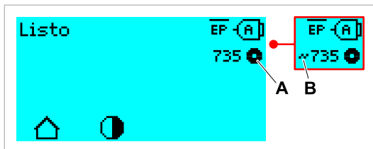
Figura 52: Indicación de la longitud de lámina restante (A, aquí: 735 m).
