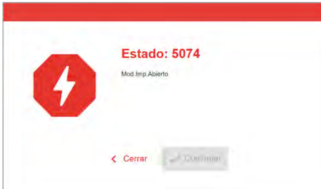
Figura 22: Los mensajes de error que requieren una reacción del operador se muestran completos. El número y el texto de estado coinciden con la indicación en el campo de mando de la máquina. El mensaje puede confirmarse, opcionalmente, en el panel web o en el campo de mando de la máquina.
