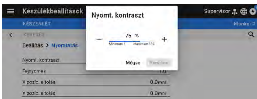
Kép 30: Példa: Nyomtatás > Nyomt. kontraszt beállítása.
