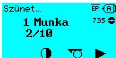
Kép 61: Leállított nyomtatási megbízás. A folytatáshoz nyomja meg a 4 gombot.
