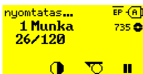
Kép 55: Fóliafigyelmeztetés egy nyomtatási megbízás alatt: A háttér sárga és a fóliaszimbólum villog.
