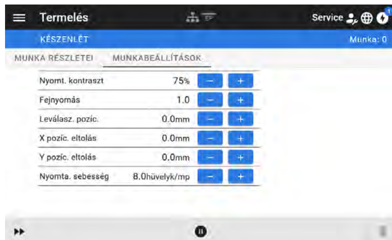
Kép 26: Egy nyomtatási megbízás “Munkabeállítások” nézete a Webpanelen. A beállítást a “+” vagy “-” jelekre kattintva módosítani lehet.
