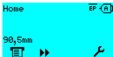
Afbeelding 49: Weergave van de gemeten etikettenafstand.
