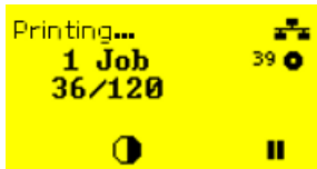
Figura 55: Alerta de folha durante um job de impressão: O fundo é amarelo, o símbolo da folha fica intermitente.
